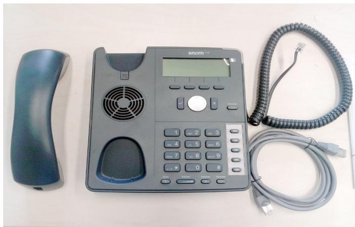
Sul retro del terminale devono essere collegate, nei rispettivi connettori RJ45, attraverso un cavo di rete Ethernet, la connessione di rete e la connessione verso il PC (se necessario): il terminale si comporta come dispositivo "passante".
